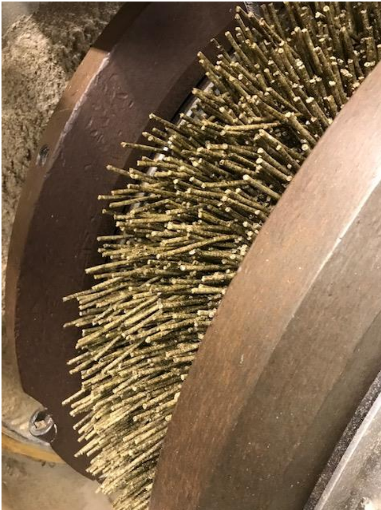
Figur 7: Foderpiller med græsprotein kommer ud af pillepressen.
